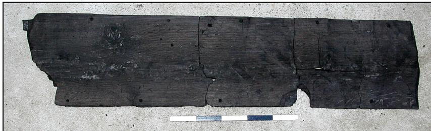
**Abb. 3:** Mainz, Holzstrasse 24 – 30. Auf der Bohle zeichnen sich die Holznägel ab, mit denen die Flachdübel fixiert wurden.
